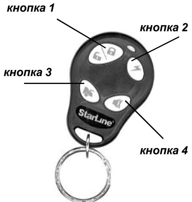
В четырехкнопочном брелке без обратной связи используется литиевый элемент питания CR2032, 3В. Время работы элемента питания зависит от частоты пользования брелком и от типа установленного элемента питания.
