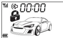
Короткое нажатие кнопки **III** во время работы автозапуска перезапускает таймер обратного отсчета времени. Долгое нажатие кнопки **III** прекращает автозапуск, двигатель выключается. Окончание работы функции автозапуска двигателя сопровождается передачей соответствующего сообщения на брелок.
