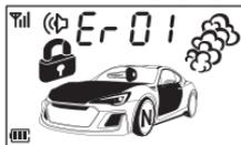
Если не закрыты двери, капот, багажник, включено зажигание, не включен стояночный тормоз, нажата педаль тормоза, селектор передач не в положении **P** (Parking), на брелок придет сообщение с номером ошибки, вызвавшей отказ (стр. 68).
