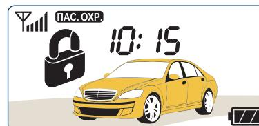
Если выбрано значение 4 программируемой функции 1-4 (см. стр. 68), то система в режим охраны не встает, а только включает блокировку стартера (зажигания) по истечении 30 сек. после выключения зажигания или по завершении режимов резервирования запуска, Pit-Stop и «Турбо».
