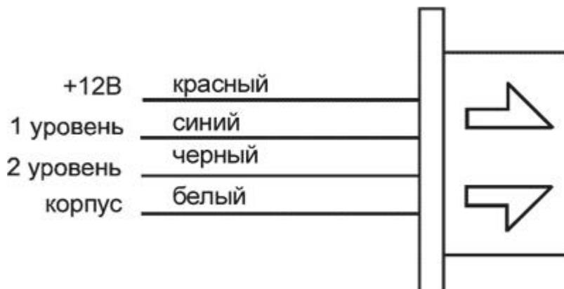
Датчик удара подключается к центральному блоку с помощью четырехпроводного кабеля, входящего в комплект сигнализации. Подача питания (потенциала корпуса) на датчик осуществляется только в режиме охраны. При включении режима охраны с отключением датчика питание на него не подается.
