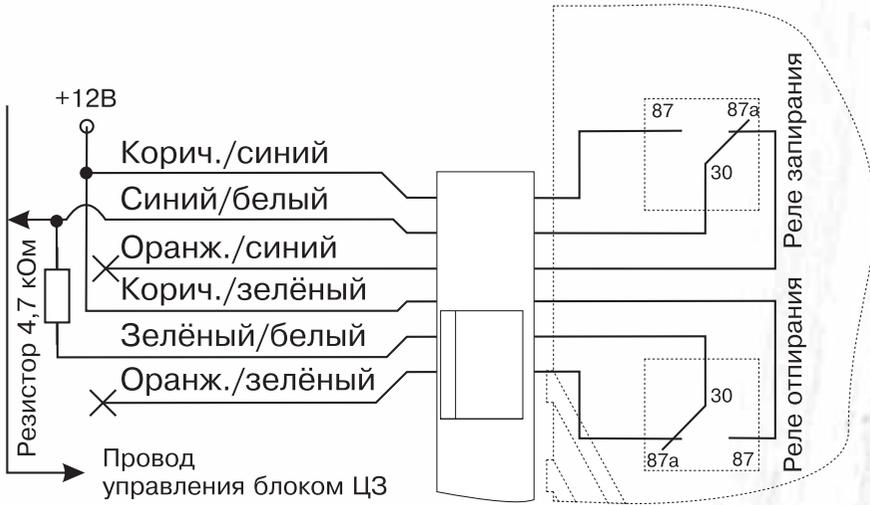
**АВТОМОБИЛИ С ОДНОПРОВОДНОЙ СХЕМОЙ УПРАВЛЕНИЯ ЦЗ, В КОТОРЫХ ДЛЯ ЗАПИРАНИЯ И ОТПИРАНИЯ ТРЕБУЕТСЯ ОТРИЦАТЕЛЬНЫЙ ИМПУЛЬС (МАССА) НА ПРОВОДЕ УПРАВЛЕНИЯ**
