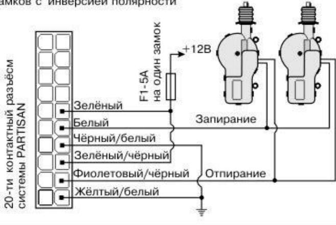
Схема подключения к блоку центрального замка (ЦЗ) с управлением импульсами отрицательной полярности
