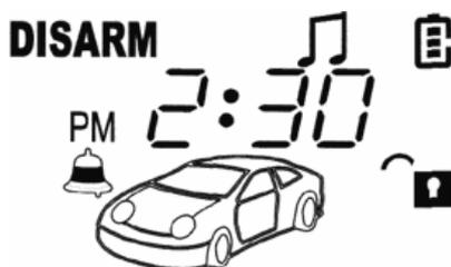
Включение функции автоматической проверки наличия 2-сторонней связи между системой и передатчиком с 2-сторонней связью (RANGE TEST).
