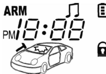
После того, как "обойденная" при включении охраны цепь будет закрыта или исправлена, система также немедленно возьмет ее под охрану.
