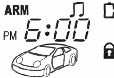
Если батарейка 5-кнопочного передатчика с 2-сторонней связью разряжена, то вместо сигналов подтверждения встроенный динамик передатчика будет подавать 5 коротких сигналов, а на ЖК-дисплее будет постоянно мигать символ разряженной ("пустой") батареи.
