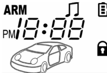
**Примечание 1:** Если СИД системы не мигает, это значит, что какая-то дверь, капот или багажник не закрыты (или одна из этих цепей неисправна) и автоматическое включение охраны невозможно. В этом случае Вы сможете включить охрану с помощью радиопередатчика.
