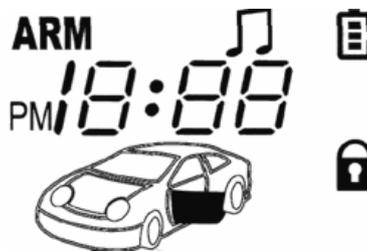
После аварийного отключения системы останется индикация режима охраны и индикация зоны (двери), вызвавшей срабатывание системы. Индикация сохранится до нажатия кнопок передатчика
