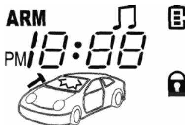
б) В отличие от триггеров дверей, багажника и капота, цепь датчика удара не влияет на автоматическое включения охраны или на автоматический перезапуск системы. Таким образом, даже если эта цепь неисправна, охрана может быть включена автоматически после выключения зажигания и закрытия всех дверей автомобиля или автоматически через 30 секунд после того, как охрана была выключена с помощью радиопередатчика.
