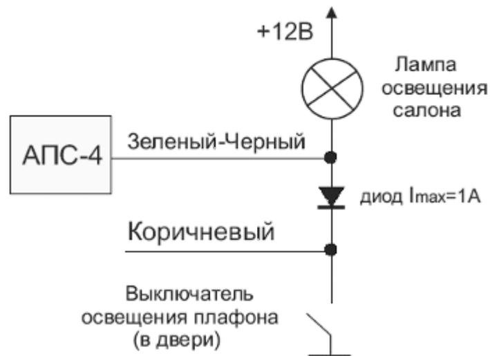
2. Рекомендуемая схема подключения КОРИЧНЕВОГО провода системы (“отрицательный триггер двери”) к проводке автомобилей ВАЗ семейства 2110 и 2115, оснащенных иммобилайзерами АПС-4:
