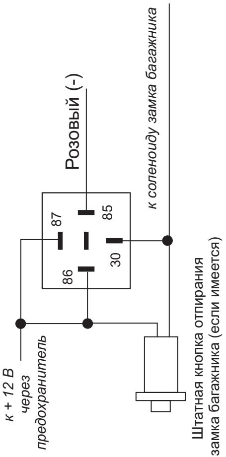
**ПОДСОЕДИНЕНИЕ ДОПОЛНИТЕЛЬНОГО Н.З. РЕЛЕ
