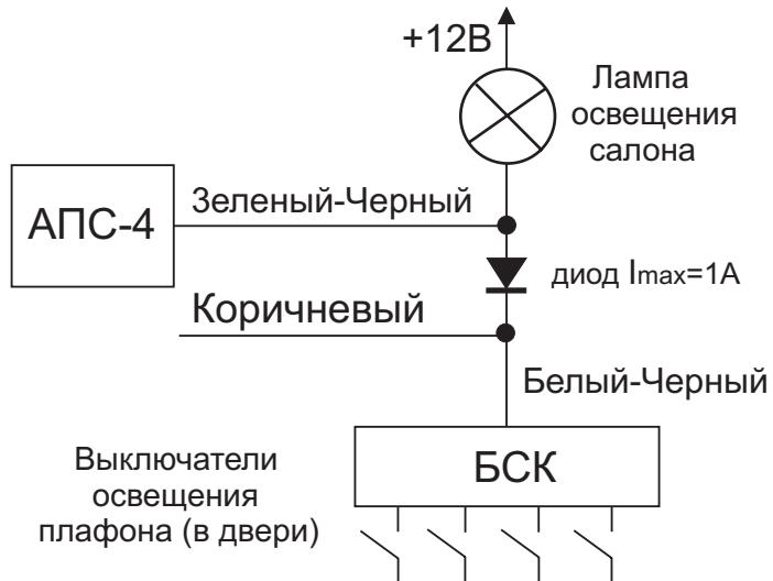
3. Рекомендуемая схема подключения ЗЕЛЕНОГО провода системы (“отрицательный триггер капота/багажника”) к подкапотной лампе автомобилей ВАЗ семейств 2109, 2115, 2123 или лампе освещения багажника автомобилей ВАЗ семейства 2115:
