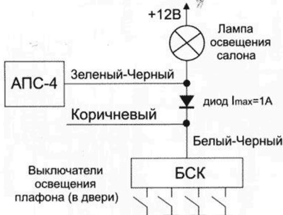
3. Рекомендуемая схема подключения ЗЕЛЕННОГО провода системы ("отрицательный триггер капота/багажника") к подкапотной лампе автомобилей ВАЗ семейств 2109, 2115, 2123 или лампе освещения багажника автомобилей ВАЗ семейства 2115:
