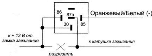
**Примечание:** Данная схема может также использоваться для подключения Розового провода (см. программирование функций Розового провода)
