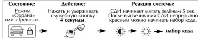
Каждое число кода набирается с помощью соответствующего количества нажатий на служебную кнопку. На время нажатия кнопки СД индикатор меняет цвет свечения на зеленый, а после отпущения – возвращается к красному свечению.
