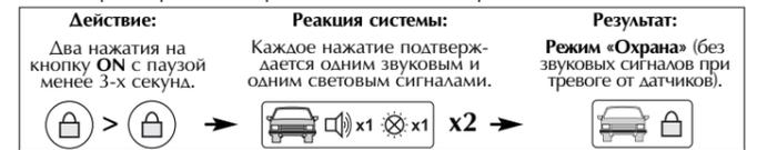
**II:** Постановка на охрану с полным отключением чувствительных датчиков. Вариант использования – охрана автомобиля во время сложных погодных условий или в праздники, при массовом использовании пиротехнических средств.
