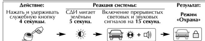
Для отмены аварийной постановки на охрану необходимо во время подачи прерывистых световых и звуковых сигналов на 4 секунды включить зажигание или повторно нажать и удерживать служебную кнопку (или замкнуть контакты считывателя любым металлическим предметом). Система вернется в режим «Неполное снятие с охраны». Для полного снятия с охраны и отключения иммобилайзера следует один раз коснуться считывателя ключом ТМ.
