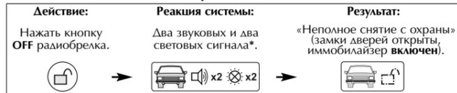
При неполном снятии с охраны система отключает охранные датчики и отпирает приводы замков дверей салона (если они установлены и подключены), но оставляет закрытым замок капота (если он установлен и подключен) и включенным встроенный иммобилайзер.
