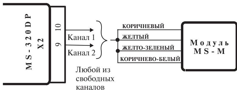
Рис. 11. Подключение модуля MS-M к автосигнализации MS-320DP для закрывания стекол при постановке на охрану
