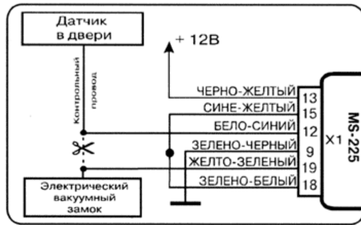
Рис. 6. Схема подключения к вакуумному центральному замку
