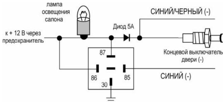
При положительных концевых выключателях дверей:
