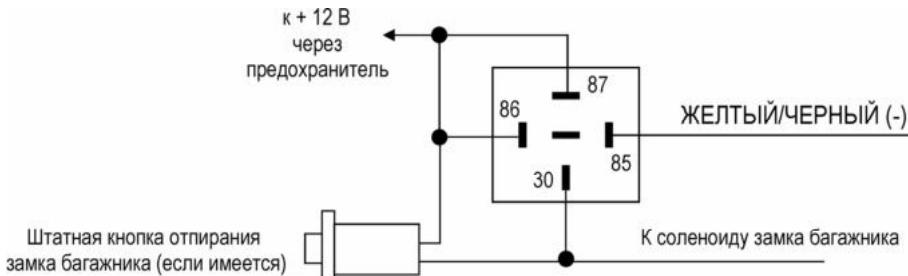
**ЖЕЛТЫЙ/КРАСНЫЙ провод:** отрицательный выход 2-го канала системы для реализации функции отпирания дверей в 2 этапа или для дистанционного управления дополнительными устройствами. Максимальный ток нагрузки 300mA, для подключения требуется дополнительное реле. Длительность импульса выходного сигнала программируется как импульсный 0,7 с, таймерный от 1 до 60 секунд (с отключением датчиков системы или без отключения датчиков) или "постоянный" ("зашелка") см. программируемое функции # 1.14.
