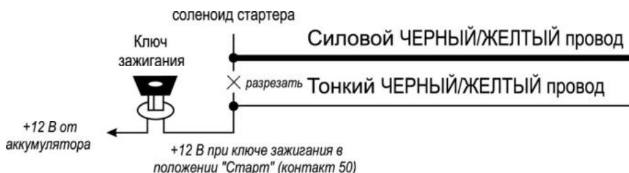
На автомобилях оборудованных кнопкой старт/стоп силовой ЧЕРНЫЙ/ЖЕЛТЫЙ провод необходимо подключить к цепи кнопки запуска и произвести программирование соответствующей функции (функция 8 вариант 3 табл. 2)
