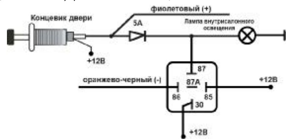
Схема подключения при включении режима охраны с работающим двигателем или турбо таймером.
