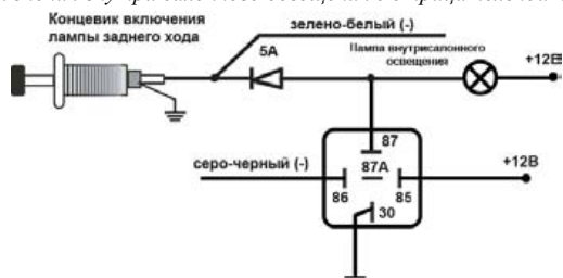
Схема подключения внутри салонного освещения с положительной полярностью
