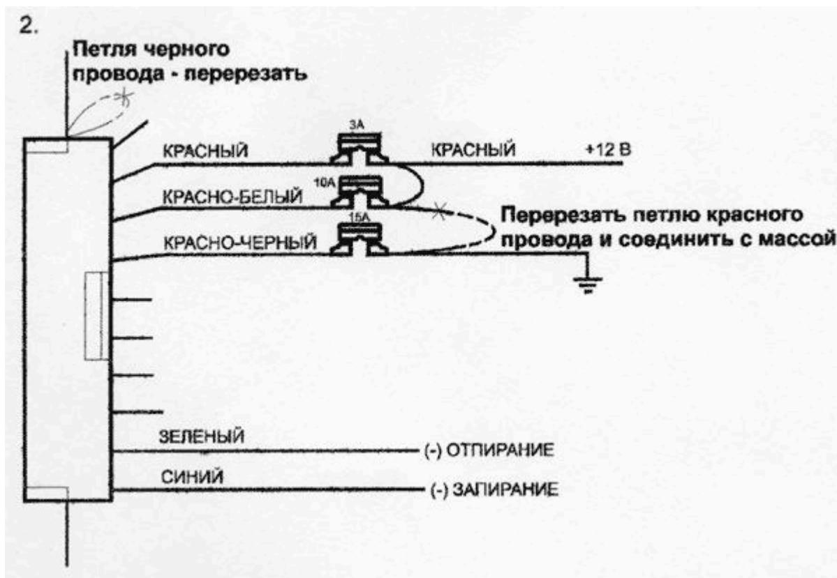
При запирании на синем проводе (-)
