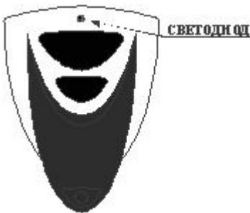
**Внимание!!!** Дальность действия радиобрелка зависит от внешних условий и от состояния элемента питания. В нормальных условиях дальность управления может достигать 30 метров. Вблизи источников интенсивных электромагнитных излучений, например, недалеко от передающих телекоммуникационных антенн, радиостанций, аэропортов, а также при разряде батареи питания радиобрелка дальность управления может уменьшаться.
