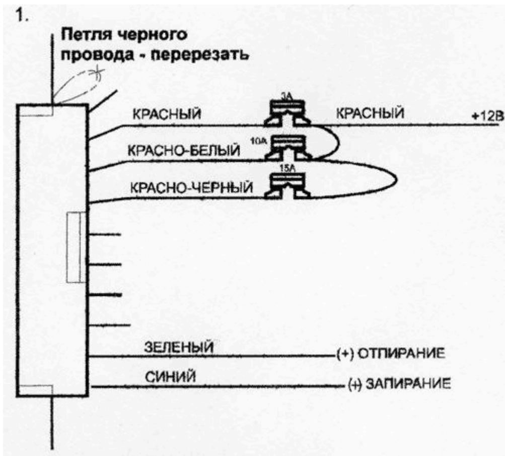
При запирании на синем проводе (+)
