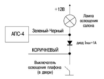
2. Рекомендуемая схема подключения КОРИЧНЕВОГО провода системы ("отрицательный триггер двери") к проводке автомобилей ВАЗ семейств 2110 и 2115, оснащенных иммобилайзерами АПС-4:
