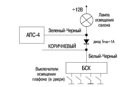
3. Рекомендуемая схема подключения ТЕМНО-ЗЕЛЕНОГО провода системы ("отрицательный триггер капота/багажника") к подкапотной лампе автомобилей ВАЗ семейств 2109, 2115, 2123 или лампе освещения багажника автомобилей ВАЗ семейства 2115:
