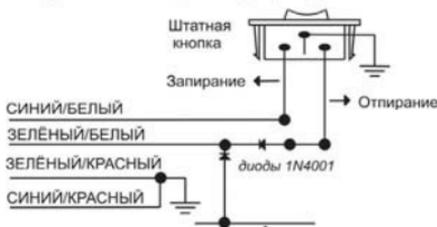
Провод, отключающий штатную сигнализацию при открытии двери ключом, или провод от замка двери, блокирующий случайное отпирание дверей
